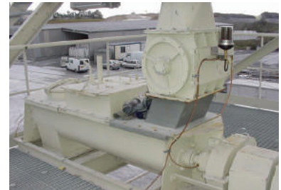
Industria del sector minero: cementera, lubricación de 4 rodamientos del tornillo sinfín de la entrada de cal.
