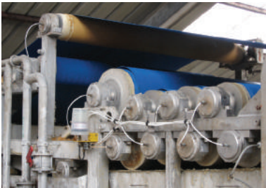
Industria alimentaria: lubricación de cojinetes de rodillos de prensa.
