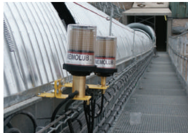
Industria minera: lubricación de cojinetes de cinta transportadora.
